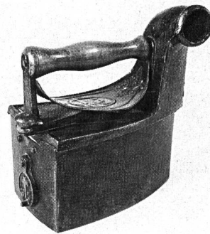
Spanisches Kohleeisen mit «Kamin» für Rechtshänder und verstellbarer Luftklappe. (Gewicht 3030 Gramm).
