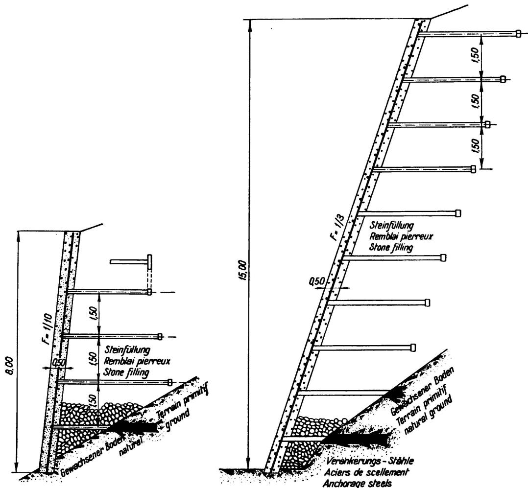
Fig. 1. Murs de soutènement à échelle, Système Coyne, Coupes transversales.
