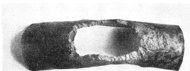
deckt. Die nähere Prüfung der schadhaften Stelle ergab, dass der 2 mm starke Bleimantel von Feldmäusen durchnagt worden war. In nebenstehender Abbildung sind die durch die spitzen, scharfen Zähne hinterlassenen Spuren deutlich sichtbar. Blei-
