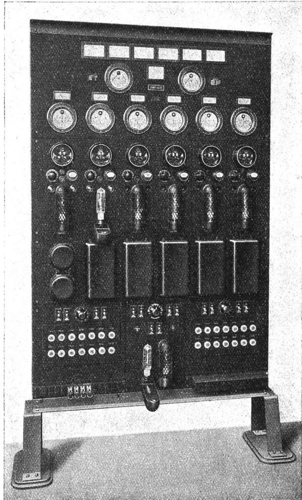
Bild 5. Tonfrequenz-Empfängergestell.
