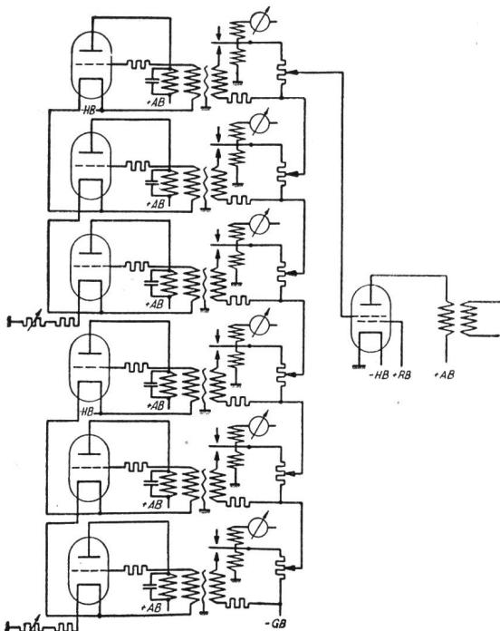
Bild 1. Tonfrequenz-Sechsfachsender.
