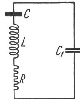
Fig. 7a. Elektrisches Ersatzschema des schwingenden Quarzkristalls.
