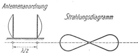
Fig. 3b. Zwei vertikale Dipole  $\lambda/2$  entfernt, gegenphasig gespeist.
