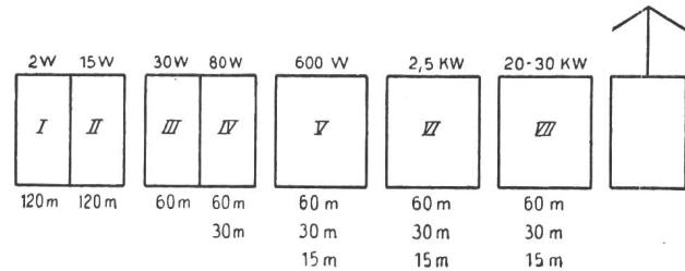
Fig. 7b. Stufenschema für statisch stabilisierte Kurzwellengroßsender (Telefunken).
