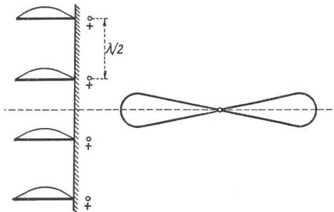
Fig. 3d. Gleichphasig erregtes Dipolbündel, Elemententfernung  $\lambda/2$ .
