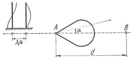
Fig. 3c. Strahlungsdiagramm des Reflektors.
