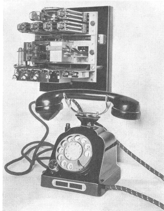
Fig. 11. Station mit Beikasten für wahlweisen Anruf.
