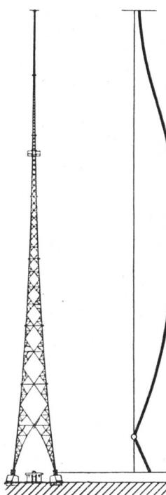
Fig. 7a: Gemessene Stromverteilung, Turm oben erregt.
