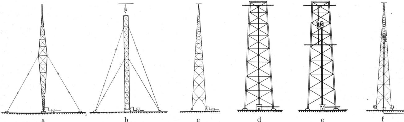
Fig. 2: Schwundmindernde Antennen. — Types d'antennes antifading.
