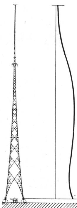
Fig. 7b: Gemessene Stromverteilung, Turm fasserregt.
