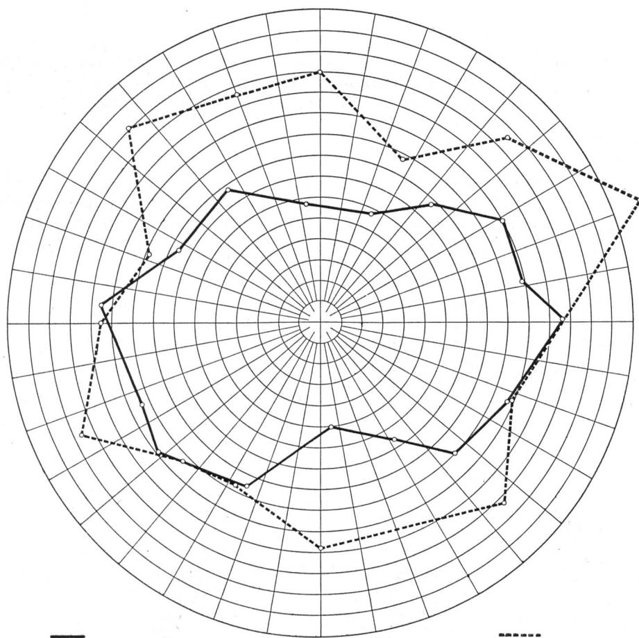
Fig. 6: Horizontalstrahlungsdiagramme des alten und des neuen Systems bei gleicher Antennenleistung.
