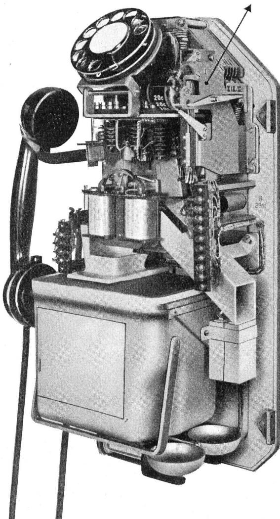
Fig. 4. Kassierstation geöffnet mit Nachzahlanzeiger.
