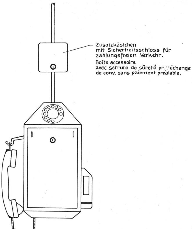
Fig. 5. Zusatzkästchen für Verkehr ohne Barzahlung an der Kassierstation.
