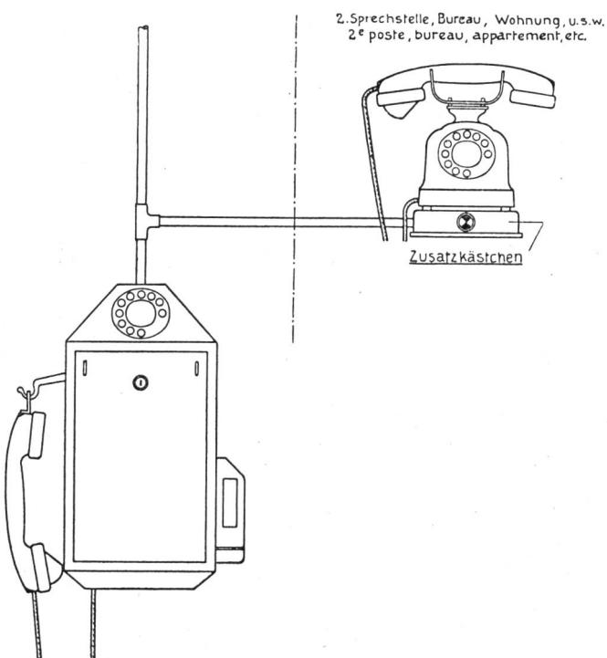
Fig. 6. Zusatzkästchen für Verkehr ohne Barzahlung an einer zugeschalteten Sprechstelle.
