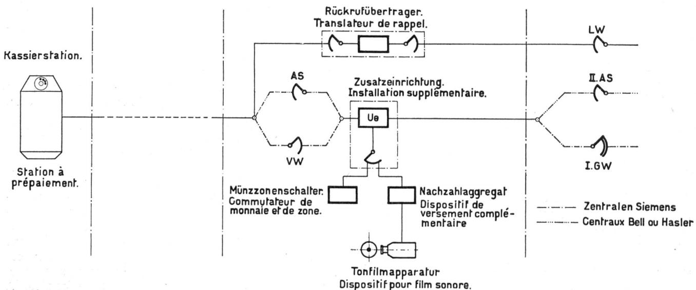
Fig. 7. Verbindungsdiagramm Zentrale. — Diagramme des connexions au central.
