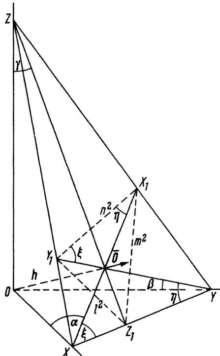
3. Les cercles de rayon  $k$  dont le plan est parallèle à  $XOY$  (et à  $XOZ$ ) ont pour projections des ellipses dont les demi-diamètres conjugués sont parallèles à  $\bar{O}X$  et à  $\bar{O}Y$  (ou à  $\bar{O}Z$ ) et valent resp.  $l$  et  $n$ . En appliquant les théorèmes d'APOLLONIUS on trouve pour le rapport  $a:b$  des axes des ellipses
