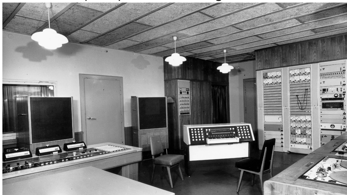
fig.1 Subharchord synthesizer inside the Labor für akustisch-musikalische Grenzprobleme.
