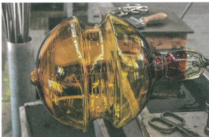
Der eingeblassene Glaskörper vor dem Abkühlen.
