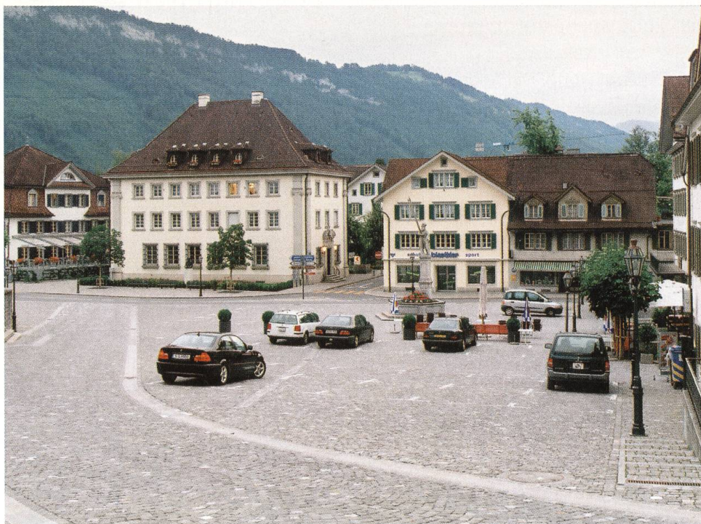
Stans, Dorfplatz. Im Vordergrund die mit einer Bogenpflasterung und Wasserrinnen leicht hervorgehobene Fahrstrasse
