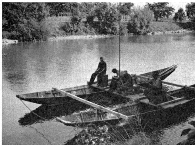
Abb. 4. Wassermessung mit hydrometrischem Flügel von Schiffen aus.
