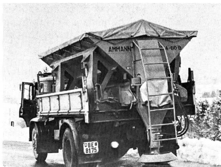
Das grösste Modell ist der Aufsatz-Salz- und Splittstreuer AMA 60B Inhalt 6 m 3 .
