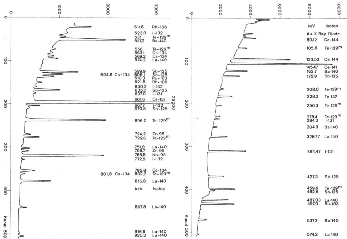
Fig. 21. Gamma-Spektrum der Spaltprodukte im Filter der Abluftüberwachungsanlage (Hochkamin) des Centre nucléaire Lucens, Sammlung 21. 1. 69 bis 30. 1. 69, Messung 24. 2. 69 mit Ge-Li-Planardiode
