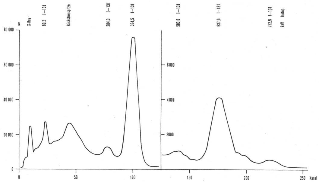
Fig. 9. Gammaspktrum einer Abwasserprobe des AKW-Beznau, entnommen 19. 12. 69, gemessen 23. 12. 69 mit NaI-Kristall  $3 \times 3$  Zoll
