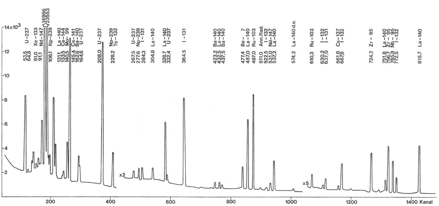
Fig. 4. Gammaspektrum einer Luftprobe aus 12 500 m Höhe (Tropopause bei 10 200 m), gesammelt und gemessen am 17. 7. 73
