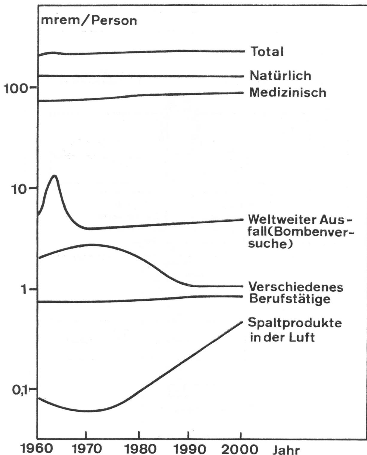
Fig. 1. Geschätzte mittlere Ganzkörperäquivalentdosen in den USA, aus (2)
