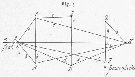
Auflagerkräfte (nämlich eine für jedes bewegliche und zwei für jedes feste Auflager) den anliegenden Knotenpunkten derart zugewiesen werden können, dass auf jeden Knotenpunkt gerade zwei daselbst eintreffende, verschieden gerichtete Stäbe oder Auflagerkräfte kommen.
