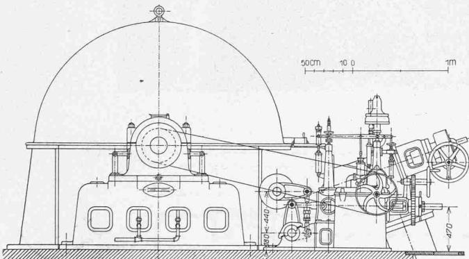
Abb. 23. Ansicht der 5500 PS-Pelonturbine der Zentrale Ackersand mit Handregulierung der Düsenadel. — Maßstab 1 : 50.
