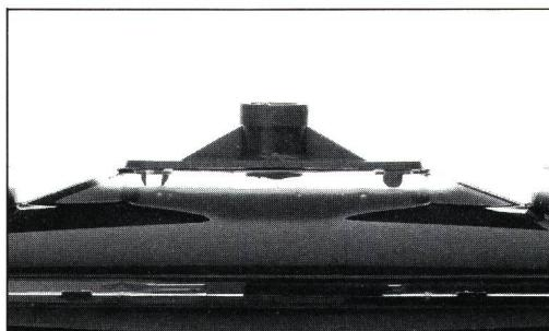
Nach dem Mischen wird die Einfülldüse auf den Ring aufgesetzt und arretiert. Gleichzeitig wird die Folie durchstossen und der Weg für das Harz frei. Der Befestigungsring verhindert, dass sich die Düse während des Vergießens löst.
