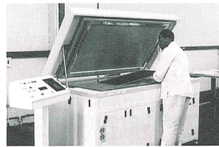
Südafrikanischer Arbeiter ver-schweisst ein PV-Panel (Bild nrel).
