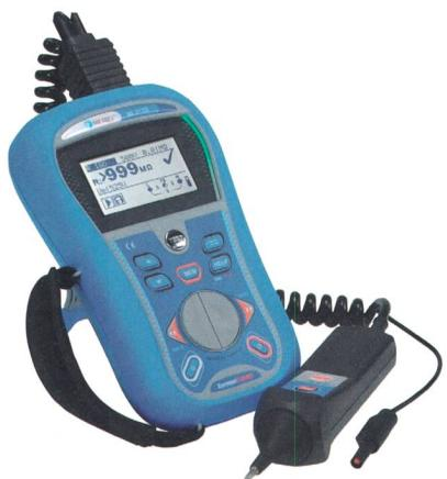
**Prüfung allstromsensitiver RCD's Typ B
