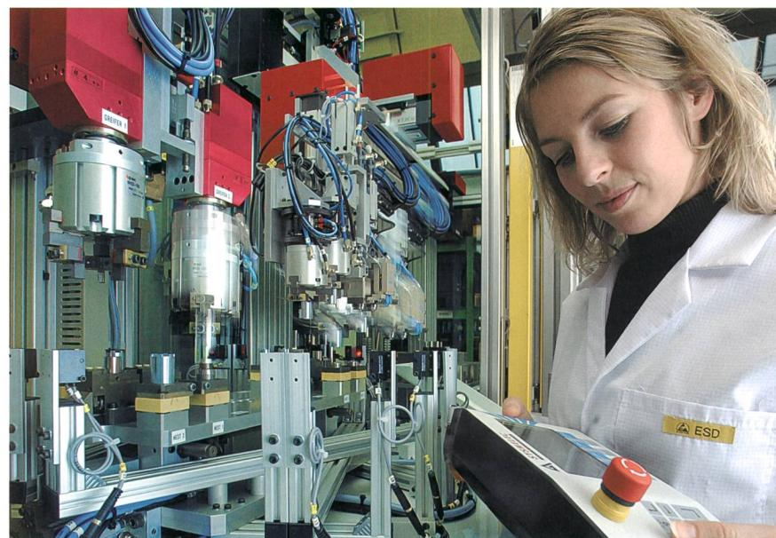
Für die Montage der Motorenbursten kommen Roboter zum Einsatz.
