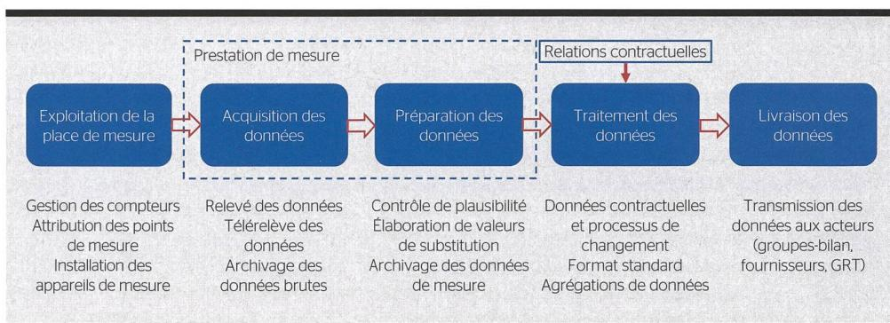
**Figure 1** Processus de mesure et de mise à disposition des données selon Metering Code Suisse (AES).
