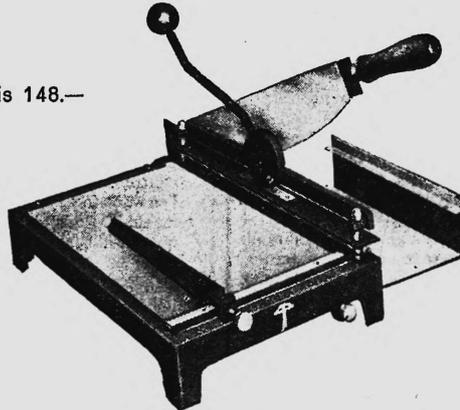
Diese Maschine ist sehr solid und stabil gebaut, Gewicht 12 kg; sie besitzt ein ganz ausgezeichnetes, elektrogehärtetes Spezialmesser für Papierbearbeitung, 36 cm Schnittlänge. Die Apparatur ist versehen mit Preßhebel und Preßschiene, sie hat einen Winkelanschlag und eine Auffangmulde, die gleichzeitig als Messerschutz dient.
