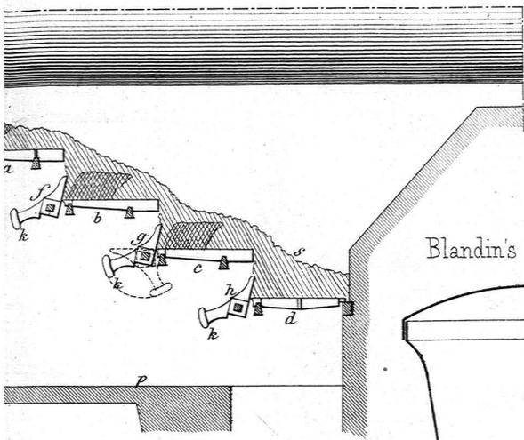
Vorrichtung zum Ziehen v. Gußstahlröhren.
