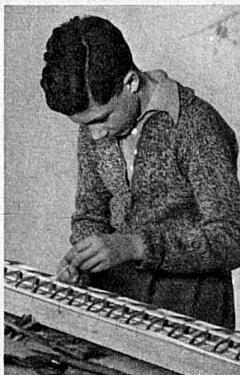
Der Bau eines Flügels verlangt ein ebenso genaues wie sauberes Bearbeiten der feinen Holzstäbchen und dünnen Sperrholzplatten – La construction d'une aile exige un travail aussi exact que soigné des petites nervures et des minces feuilles de contreplaqué
