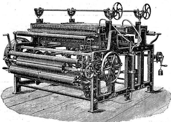
für Läng- und Querreibung gleichzeitig, mit beliebiger Ein- und Ausrückung für Längs- oder Querreibung. Patentierte, auf Luftkissen federnde Messeranordnung. Effekt der Querreibung besonders günstig gegenüber andern Systemen, da vermittelt je zwei Messerrei-en die **ganze Breite** des Stoffes von links nach rechts und umgekehrt gerieben wird.
