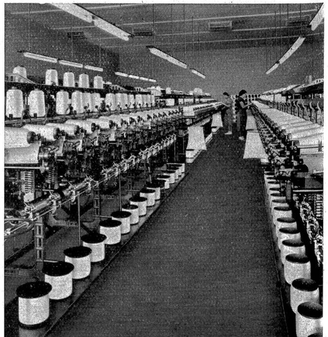
Präzisions-Kreuzspulmaschine «MONOFIL-KONER» zur Herstellung von Pineapple-Konen.
