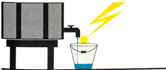
Bringt man zwei nichtaufgeladene Körper, von denen mindestens einer elektrisch nicht leitend ist, in intensive Berührung und trennt sie dann rasch wieder voneinander, so laden sie sich elektrostatisch auf.
