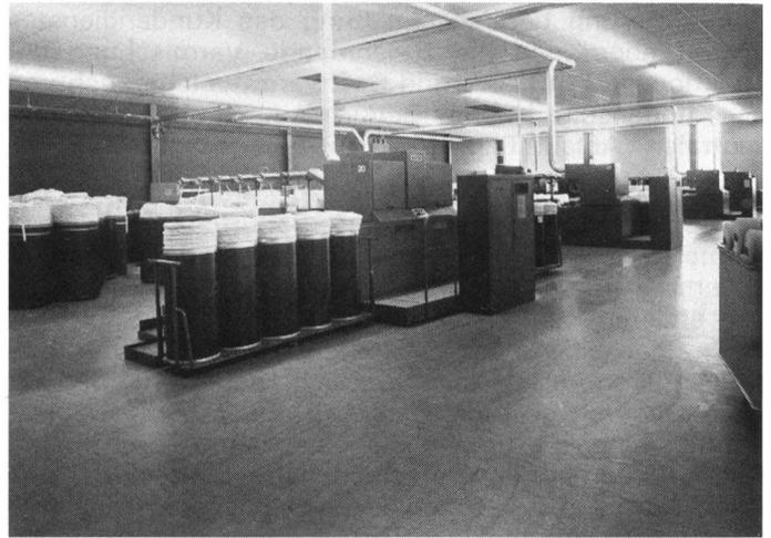
Im Vordergrund die doppelköpfige Strecke D1/2. Die neuesten technologischen Erkenntnisse wurden hier verwirklicht. Der Rolleneinlauf wird auch bei sehr hohen Geschwindigkeiten einen sicheren Bandabzug. Fehlende Bandstücke gibt es mit dem D1-Konzept nicht mehr.
