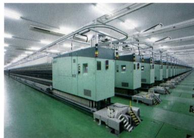
Abb. 6: Die Ringspinnmaschine G 35
