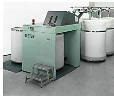
Abb. 3: Die neue Einkopf-Strecke SB-D 11
