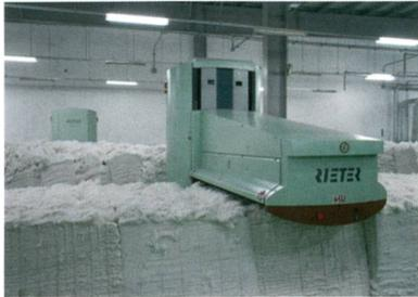
Abb. 1: Der automatische Ballenöffner UNIfloc A 11
