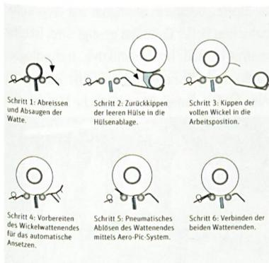
Abb. 4: Einzigartiges automatisches Wickelwechsel- und Wattenansetzsystem
