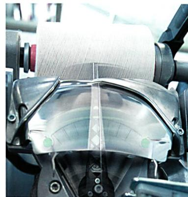
Abb. 2: Das neue trommellose Fadenverlegesystem Preci FX
