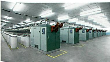
Abb. 8: Die Rotorspinnmaschine R 40
