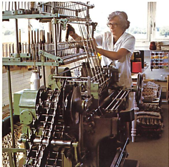
Häkelmaschine. Das Dessin wird durch die lange Kette gesteuert.
