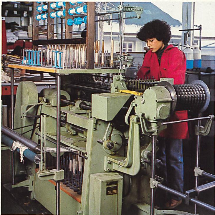
Musterwebstuhl mit 28 Schäften und Drehervorrichtung / Métier à tisser d'échantillonage à 28 lames et dispositif pour armure simili-gaze / Loom for the making up of patterns with 28 heddles and gauze device / Telaio modello con 28 licci e dispositivo da giro.
