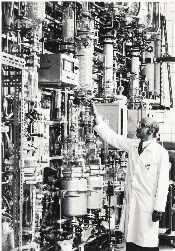
Im Zentralbereich Forschung und Entwicklung stehen Laboratorien zur Verfügung, in denen im Rahmen der Polymerforschung neue und modifizierte Dralon®-Rohstoffe erarbeitet werden. In halbtechnischen Apparaturen (unser Bild) wird die Übertragung der Verfahren vom Laboratorium in die grosstechnische Produktion vorbereitet.
