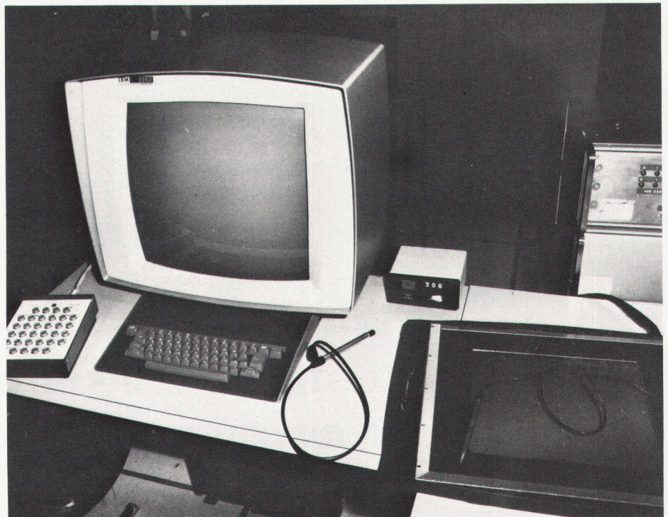
Figure 1: Der an einen Grosscomputer IBM 360/67 angeschlossene Terminal. In der Mitte der interaktive Bildschirm IBM 2250 mit Tastatur und Lichtstift, links die u. a. mit einem Zeichentisch verbundene Funktionstastatur, welche es ermöglicht, das Bild auf dem Bildschirm in «fester» Form zu erhalten. Rechts das Digitalisierungsgerät, das die Übertragung von einer Zeichenpause auf den Bildschirm gestattet.
