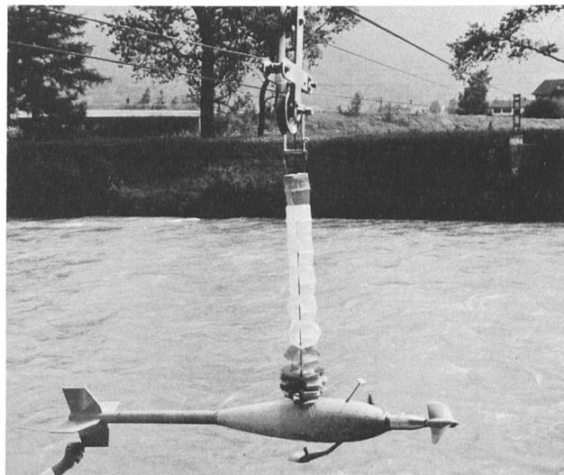
Foto di sopra. Dettaglio di un mulinello fissato al pesosonda (salmon). Il salmon, massa profilata a forma di pesce, con il timone stabilizzatore può essere spostato orizzontalmente ed in profondità per la misura della velocità nel punto desiderato del corso d'acqua. I segnali del mulinello come pure quelli del toccafondo (visibile sotto il peso) sono trasmessi via conduttore elettrico.
