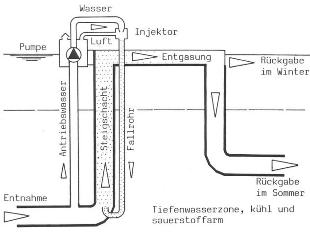
Bild 3. Die Funktionsweise des Seeluftungsgerätes im Hüttnersee.
