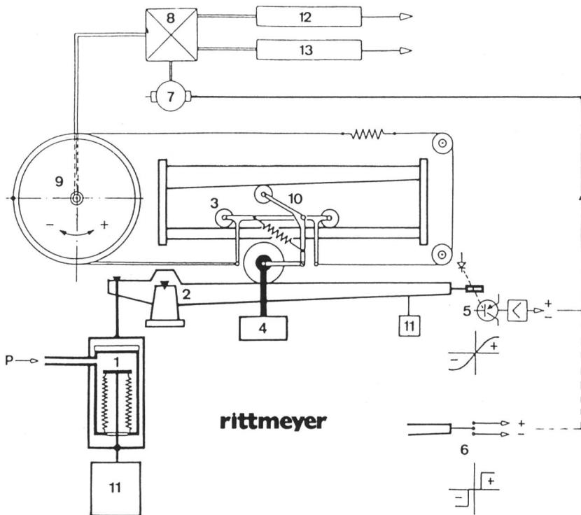
Bild 2. Präzisions-Druckwaage.
