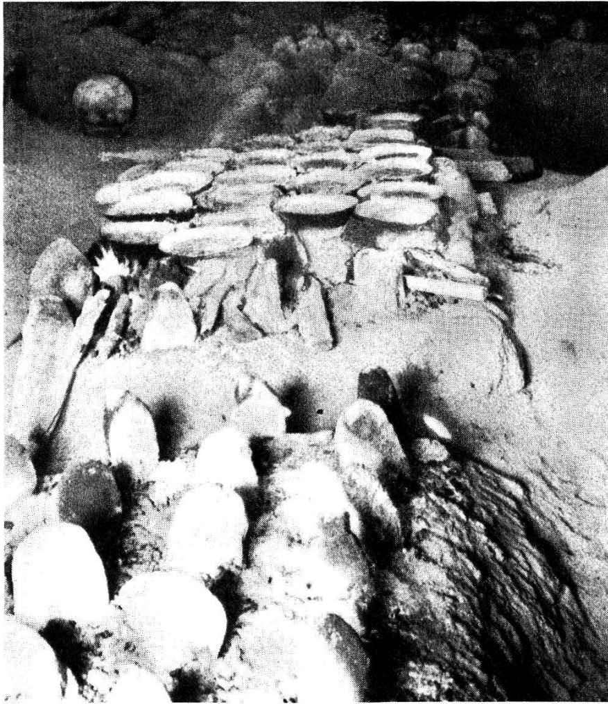
Abb. 1. Inneres einer Salzküche. Man erkennt deutlich die Anlage der Roste, das Holzfeuer und die irdenen Schüsseln mit der kochenden Sole.
