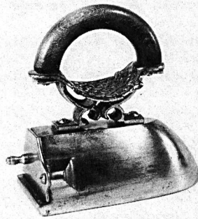
Vernickeltes Eisen in «Westfäler-Form» um 1900, Gewicht 2900 Gramm.
