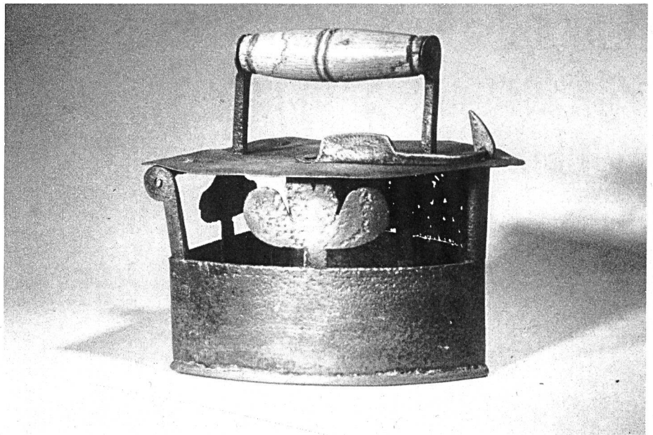
Handgearbeitetes Bügeleisen mit geschlossener Seite zum Schutz gegen austretendes Gas. Toscana 1750–1800 (Gewicht 1660 Gramm).
