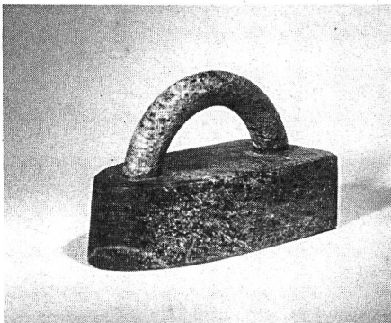
«Speckstein»-Bügeleisen aus Gotthard-Serpentin. Vorteil: sie speicherten die Wärme über Stunden hinweg.
