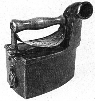
Spanisches Kohleeisen mit «Kamin» für Rechtshänder und verstellbarer Luftklappe. (Gewicht 3030 Gramm).
