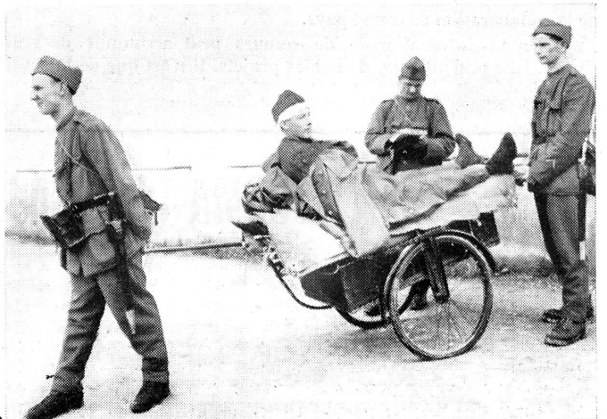
Für Verwundetentransport eingerichteter Fahrradanhänger.
