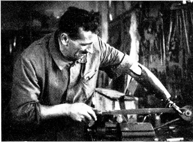
Ajusteur amputé de la main gauche continuant son métier avec une prothèse.
