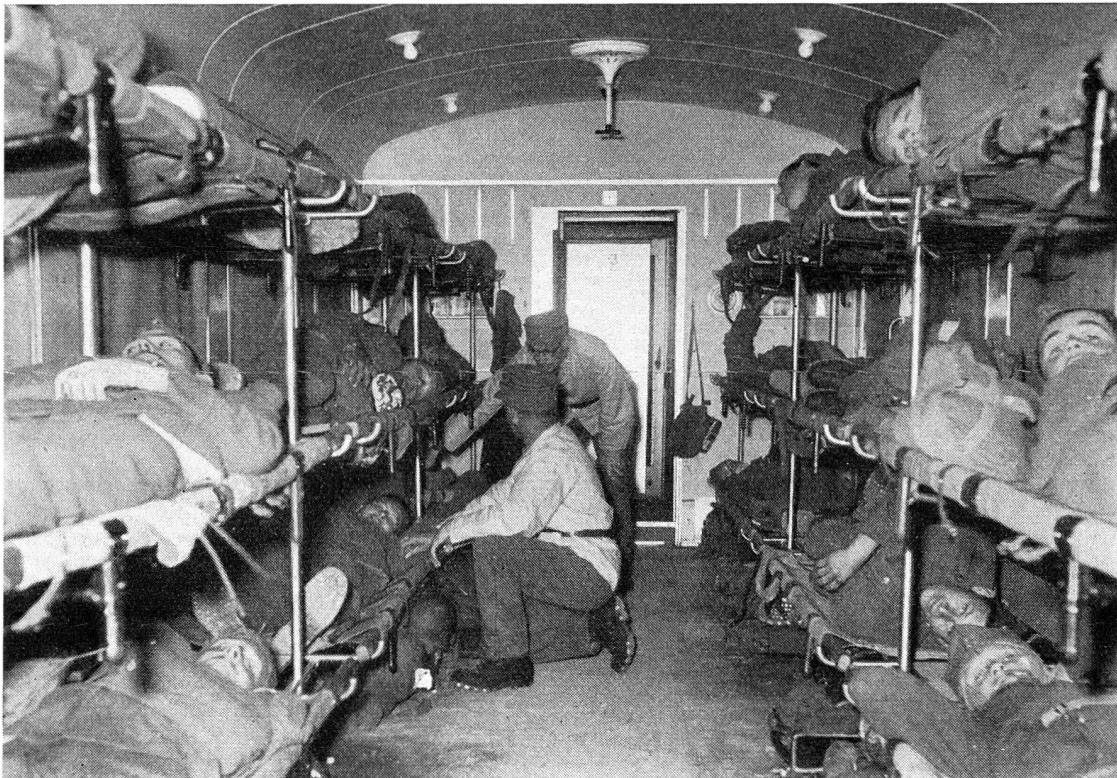
Pendant les manœuvres de notre service de santé, un wagon du train sanitaire (wagon ordinaire où des porte-brancards remplacent les sièges rapidement démontés). Un train sanitaire permet le transport de 336 blessés. (Photopress, Zurich.)
