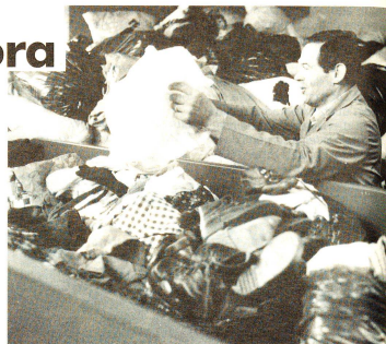
Ogni sacco viene aperto e il contenuto messo sul nastro trasportatore.
