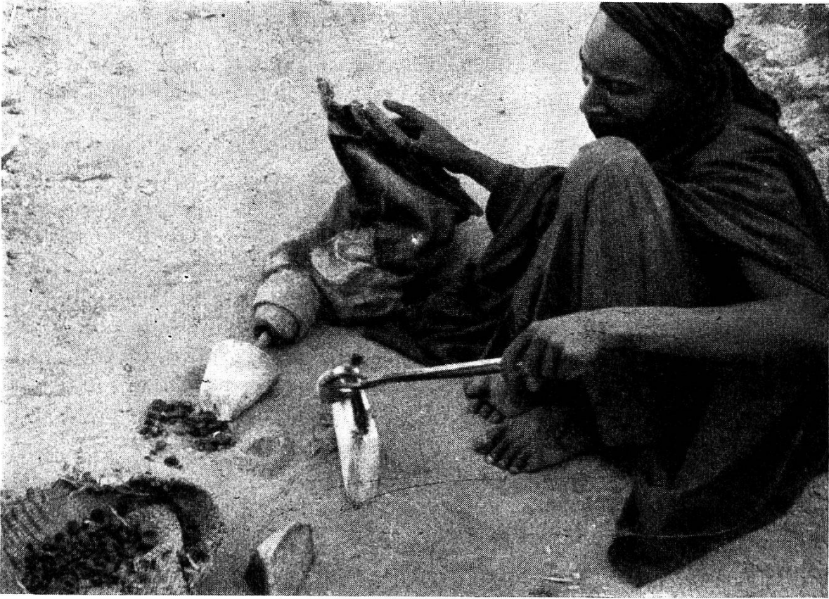
Photogr. 15. Un forgeron d'Agadès vient de faire fondre de l'argent et le coule dans une lingotière, ce qui lui permettra de forger la tige de métal et d'en faire un bijou. Il se sert d'un soufflet à outre simple.
