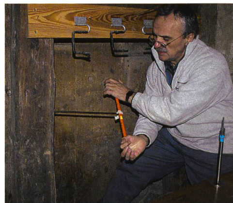
Abb. 6: Trivun Sormaz, der neue Mitarbeiter im Dendrolabor, bei der Entnahme einer Bohrprobe im Haus Nr. 120 in Avers, Cresta.
