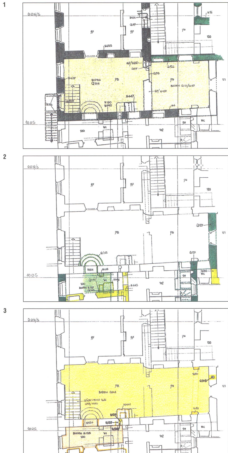
Abb. 17.1–3: Val Müstair, Kloster St. Johann in Müstair, Westtrakt, Pfortenhalle 98. Drei Entwicklungsschritte vom zweiräumigen Obergeschoss 1 nach 1499 über den Verbindungsraum mit Treppenstufen nach 1539 2 zur vereinheitlichten und gewölbten Pfortenhalle von 1627 3 . Mst. 1:200.
