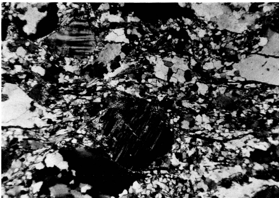
FIG. 6. — Arkose quartzito-séricitique à microcline n° 5 M. Lumière polarisée. G = 20 ×.
