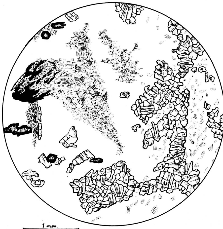
FIG. 41 (pl. m. 72 V). — Gabbro à phénocristaux de plagioclase nombreux. La zone interstitielle triangulaire, entièrement chloritisée et amphibolisée, avec mica et stilpnomélane ou biotite (vert). Les phénocristaux de plagioclase sont transformés en albite, variété d'épidote, phyllite; présence de tourmaline et de deux petites aiguilles d'apatite. Grain d'ilménite déformé et altéré.
