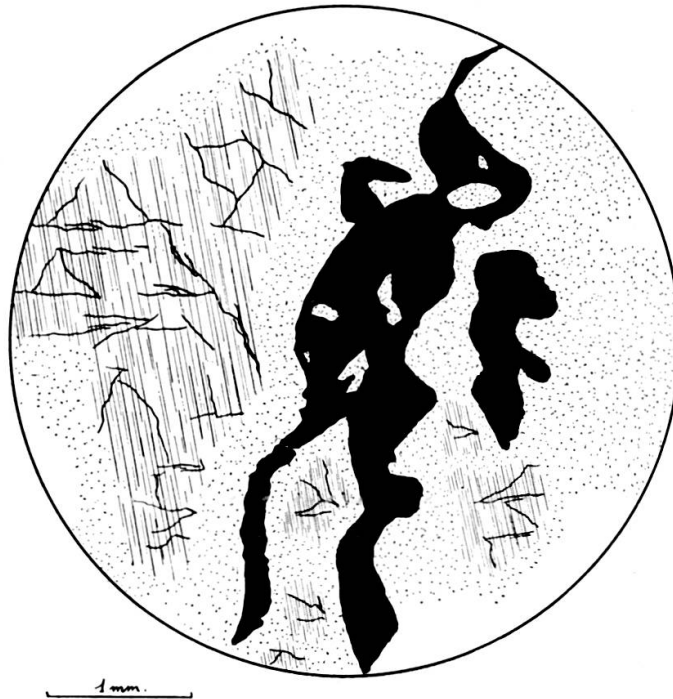
FIG. 37 (pl. m. 71 V). — Grande plage de pyroxène (avec clivages) amphibolisée et chloritisée englobant un grain d'ilménite leucoxénisée. (en noir)
