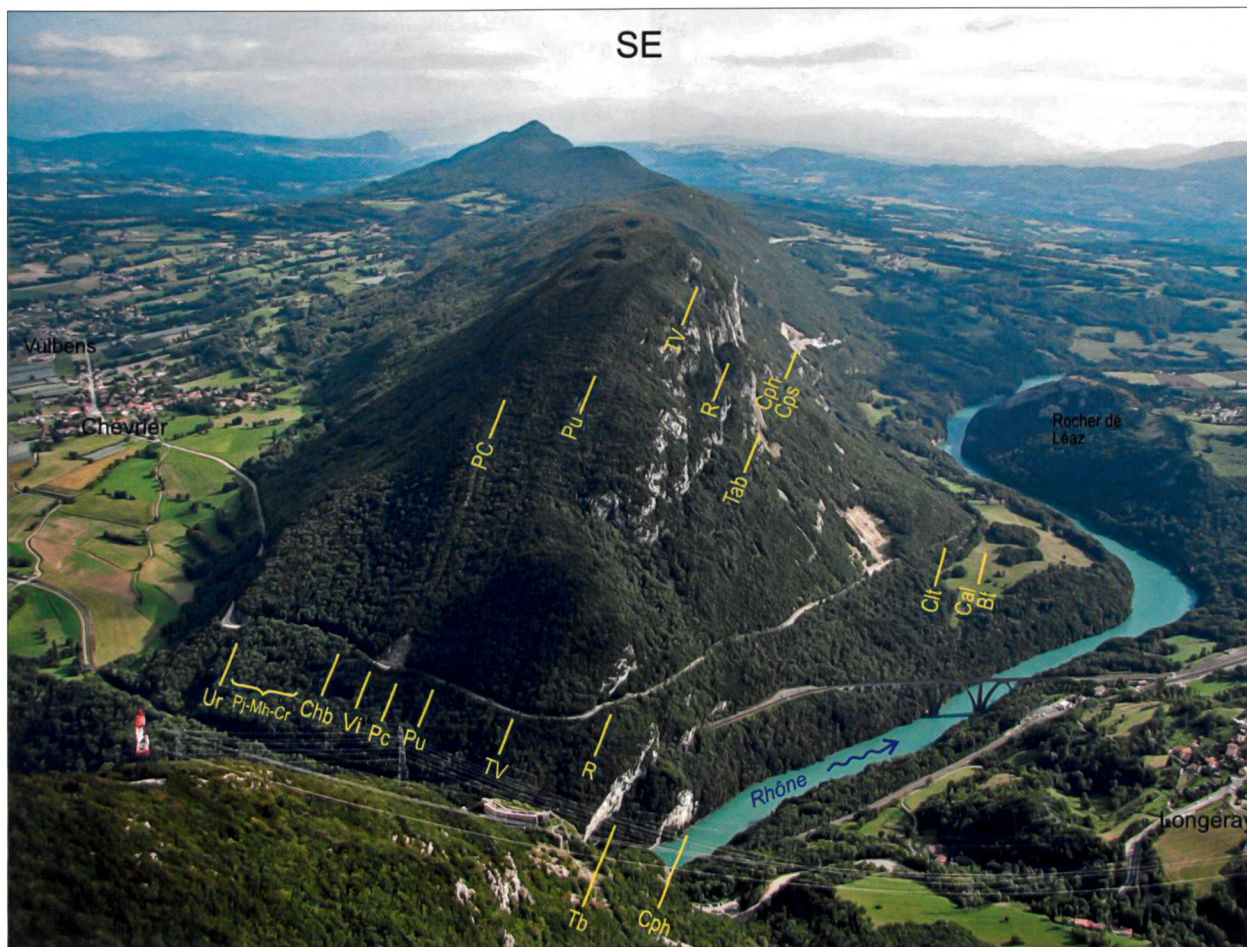
Fig. 5: Vue en direction du SE, sur la partie septentrionale du Vuache depuis le Plat des Roches, au-dessus du Fort l'Ecluse (photo D. Ernst). Position des affleurements de la série mésozoïque le long de la D908a, entre Chevrier et Arcine. Bt: Marnes des Monts d'Ain (Bathonien moyen); Cal: Calcaires d'Arnans (Callovien); Clt: Calcaires lités (Oxfordien supérieur); Cps: Calcaires pseudolithographiques (Oxfordien terminal); Cph: Couches à céphalopodes (Kimméridgien inférieur – base du Kimméridgien supérieur); Tab: Calcaires de Tabalcon (Kimméridgien supérieur l. s.); R: Complexe récifal (Kimméridgien supérieur l. s.); Tv: Tidalites de Vouglans (Tithonien l. s.); Pu: Formation de Goldberg (Berriasien inférieur); Pc: Formation de Pierre-Châtel (Berriasien moyen); Vi: Formation de Vions (Berriasien supérieur p. p.); Chb: Formation de la Chambotte inférieure (Berriasien supérieur p. p.); Cr: Calcaires roux auct. (Valanginien inférieur); Mh: «Complexe des Marnes d'Hauterive» auct. (Valanginien sommital – Hauterivien inférieur basal); Pj: «Complexe de la Pierre jaune de Neuchâtel» auct. (Hauterivien inférieur – Hauterivien supérieur basal); Ur: Calcaires urgoniens auct. (Hauterivien supérieur-Barrémien inférieur).
