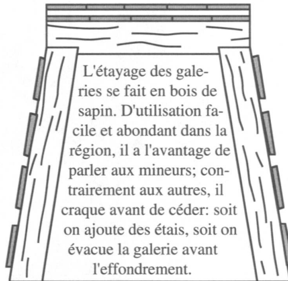
Profil d'étagage dans une galerie de fond
