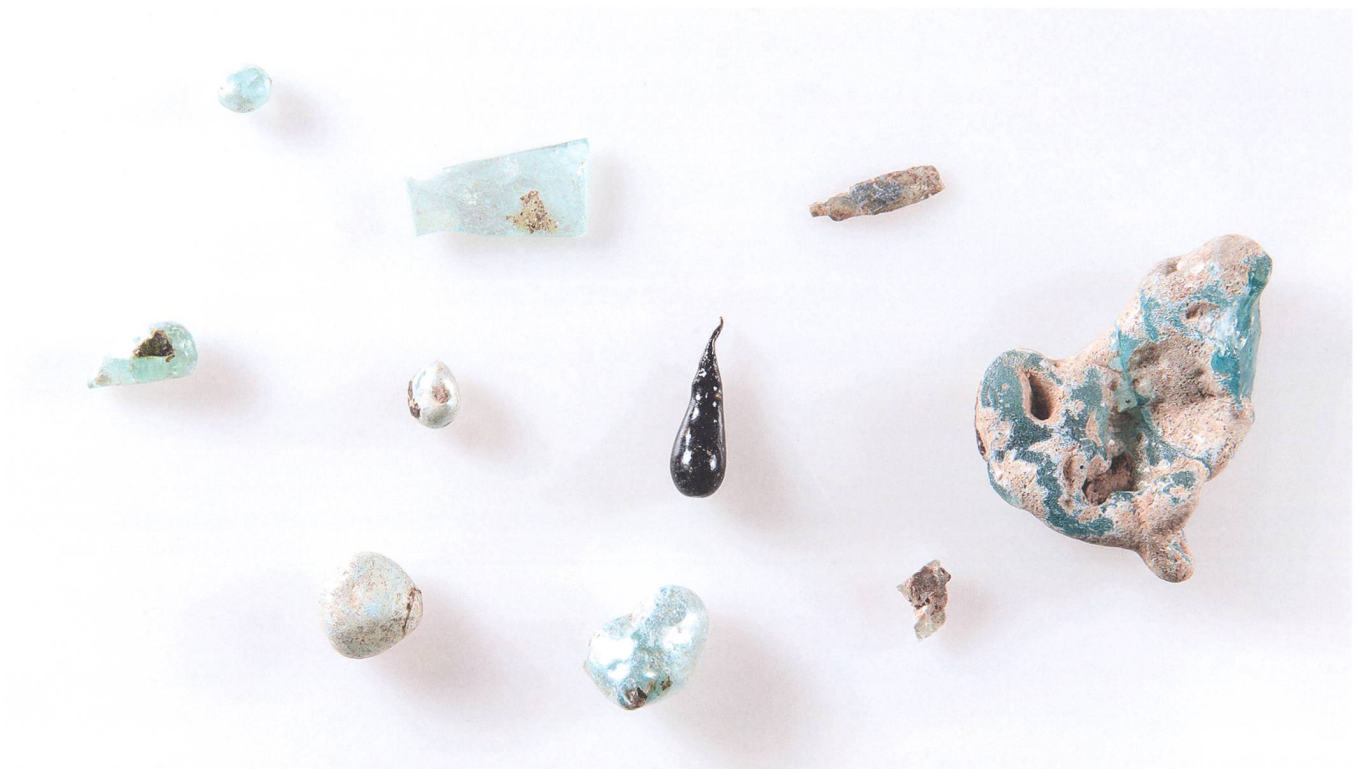
Abb. 352: Chur, Süsswinkulgasse Nr. 9. Glasreste und Glasfluss aus dem Ofen. Mst. 1:1.
