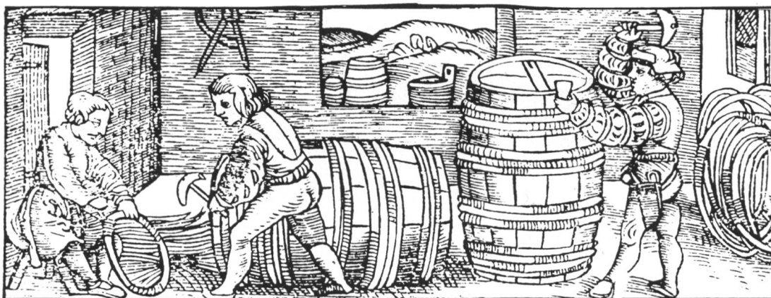
Fig. 17 Atelier de tonnelier; gravure parue en 1518. On reconnaît de gauche à droite: la fabrication des cercles en bois souple (et non en fer comme de nos jours) et deux étapes du cerclage des tonneaux. A noter la forme asymétrique du maillet à gauche (comme sur les emblèmes sculptés de Riquewihr) et la trousse de tonnelier attachée à la ceinture du personnage de droite. Le compas accroché au mur apparaît quelquefois sur les emblèmes. Bien que l'outillage de tonnelier soit très diversifié, on retrouve presque toujours les mêmes outils sur les emblèmes. Au XVI e siècle, c'est le maillet (Schlegel) qui passe généralement pour l'instrument-type du tonnelier.
