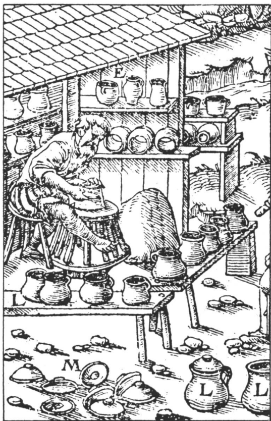
Fig. 49 Potier à son tour, gravure extraite de: G. Agricola, VOM BERGWECK ..., Bâle 1557. Le potier confectionne des récipients utilisés pour purifier le minerai. On distingue les pots mis à sécher avant d'être cuits et la motte de terre glaise qui a dû subir un traitement approprié pour la débarrasser de ses impuretés et la rendre homogène. Le potier actionne le tour avec son pied droit et s'aide d'un lissoir pour achever la finition du pot.
